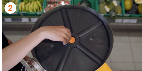
2 Irrota syöttölaudan ruuvaamalla keskimäinen ruuvi irti.
