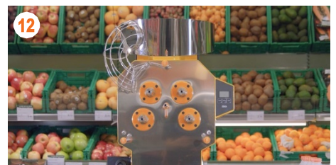
12 Puhdista koneen etuosa pehmeällä sienellä ja saippuvedellä.
