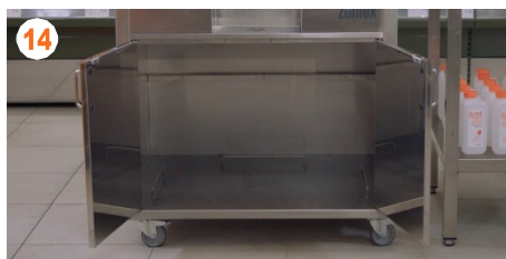
14 Puhdista rungon sisäosa pehmeällä sienellä.
