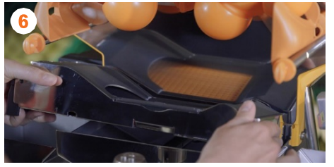
6 Irrota jätehihna-yksikkö nostamalla kokonaisuus pois mehukaukalon päältä.
