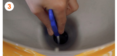
3 Aseta puhdistusharja syöttölaitteen rungossa olevaan viemäriaukkoon, ja poista kaikki jäämä, jota saattaa löytyä putkesta.
