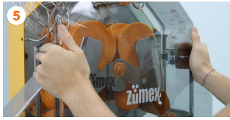
5 Käännä nipat osoittamaan klo 12 ja irrota etukansi sekä sivukannet.
