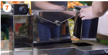
7 Irrota ruostumattomasta teräksestä olevat kuorienohjaimet.
